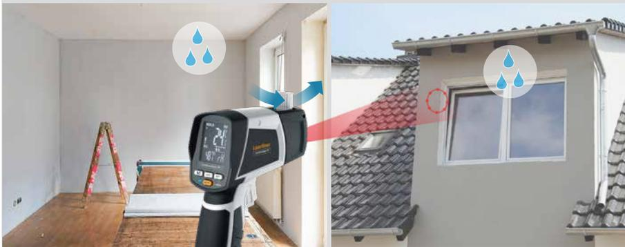
Oberflächentemperatur < Taupunkttemperatur = Feuchtigkeitskondensation
