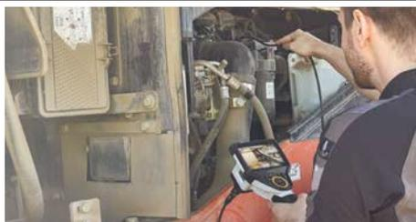
**Professionelles und hochauflösendes Videinspektionssystem mit wechselbarer Front- und Seitenansicht**
