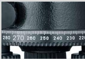
Horizontalkreis mit endlosem Seitenfeintrieb zum präzisen Anvisieren.
