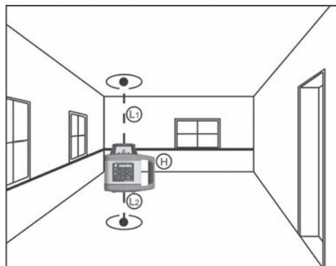
Laser **SIRIUS 1 HV** wyposażony jest w funkcję samopoziomowania automatycznie wyrównującą pochylenie urządzenia do 5° w każdym kierunku.
