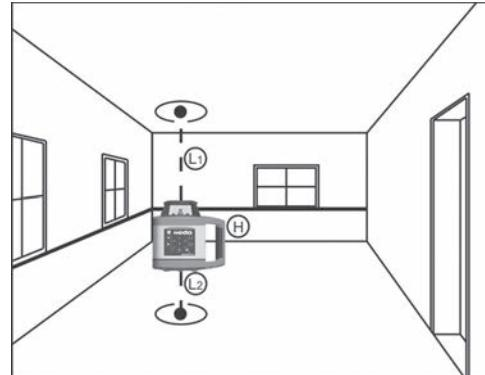
El **SIRIUS 1 HV** está provisto de una autonivelación y compensa posiciones oblicuas del aparato hasta 5° en cada dirección.
