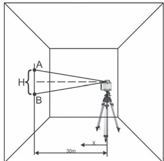
**Примечание:** Если измеренное по вертикали расстояние **H** между отметками **A** и **B** находится вне пределов допуска, то нужно проверить **SIRIUS 1 HV** в специализированной организации или на фирме NEDO.
