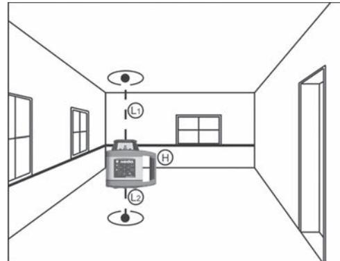
**SIRIUS 1 HV** имеет систему самовыравнивания, которая автоматически компенсирует наклон прибора до 5° в любом направлении.
