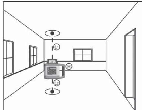
Der **SIRIUS 1 HV** ist mit einer Selbstnivellierung ausgestattet und gleicht Schräglagen des Gerätes bis zu  $5^\circ$  in jede Richtung automatisch aus.
