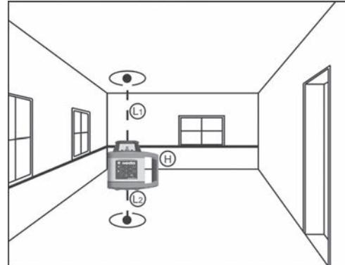
Il **SIRIUS 1 HV** è dotato di un autolivellamento e porta automaticamente in equilibrio le posizioni inclinate dell'apparecchiatura fino a 5° in ogni direzione.
