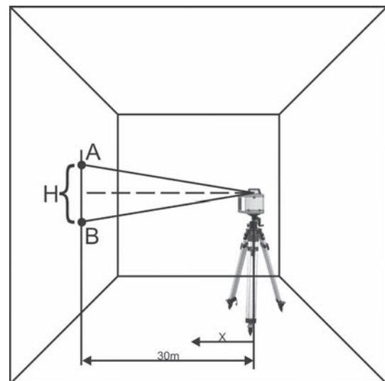
**Opmerking:** Ligt de loodrecht gemeten afstand **H** tussen markering **A** en markering **B** buiten het tolerantiebereik, dan moet de **SIRIUS 1 HV** door een erkende klantenservice of door NEDO gecontroleerd worden.
