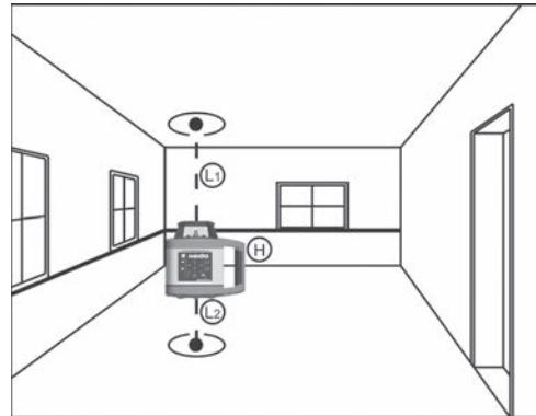
De **SIRIUS 1 HV** wordt altijd automatisch waterpas gezet en compenseert schuinstanden van het instrument tot 5° in iedere richting automatisch.
