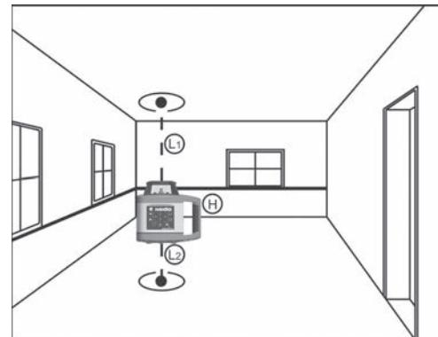
**SIRIUS 1 HV** je vybaven funkcí samočinné nivelačce, která automaticky vyrovnává šikmou polohu přístroje až do odchylky 5 ° v kterémkoliv směru.
