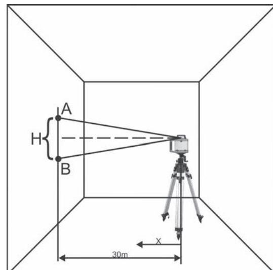
**Nota:** Cuando la distancia medida a plomada **H** entre la marca **A** y la marcación **B** se encuentra fuera del rango de tolerancia, el **SIRIUS 1 HV** debe ser verificado por un servicio postventa autorizado o por NEDO.
