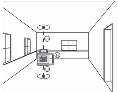
**SIRIUS 1 HV** är självnivellerande och utjämnar automatiskt snedlägen hos apparaten på upp till 5° i varje riktning.
