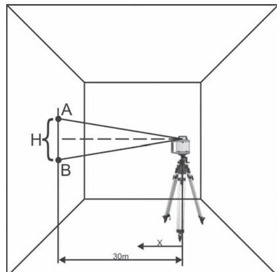
**Upozornění:** Je-li vertikálně naměřená vzdálenost **H** mezi značkou **A** a značkou **B** mimo rozsah tolerance, je nutné nechat přístroj **SIRIUS 1 HV** přezkoušet v autorizovaném zákaznickém servisu nebo ve firmě NEDO.
