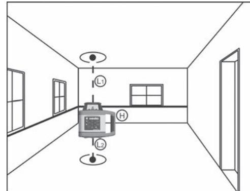
Le laser **SIRIUS 1 HV** est doté d'un nivellation automatique qui aligne automatiquement l'inclinaison de l'appareil jusqu'à 5° dans chaque direction.
