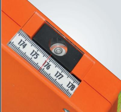
Auf der Analoganzeige des Nedo Laser mEssfix-S kann bequem der Höhenunterschied zwischen der Null-Linie des Laserempfängers und dem Aufsetzpunkt des Laser mEssfix-S abgelesen werden.
