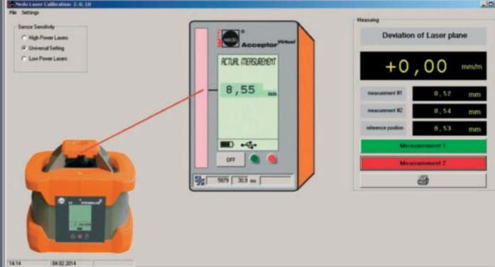
Nedo Laser Calibration 2 zeichnet sich durch eine intuitiv bedienbare Benutzeroberfläche aus. Die Genauigkeit des untersuchten Rotationslasers kann direkt in mm/m abgelesen werden.
