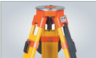
Geodäten bevorzugen für Hochpräzisionsinstrumente jedoch Holz-Stative. Im Vergleich zu Aluminium-Stativen haben Holz-Stative bei Vibrationen ein besseres Dämpfungsverhalten. Darüber hinaus reagieren Holz-Stative unempfindlicher auf Temperaturschwankungen. Die Holzteile aller Nedo Holz-Stative werden durch die Beschichtung mit einem Hightech Kunststoffmaterial dauerhaft vor Feuchtigkeit geschützt. Dadurch sind Nedo Holz-Stative extrem witterungsbeständig und robust.
