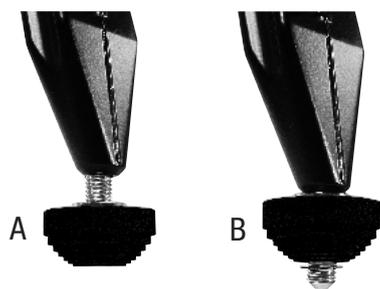
Bei Arbeiten auf rohen Böden wird die Gummikugel zurückgeschraubt, die Schuhspitze ist wirksam (Bild B). Bei Arbeiten auf empfindlichen Böden überdeckt die vorgeschraubte Gummikugel die Stativspitze (Bild A).
